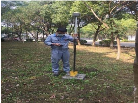
RTK 管口高程测量
